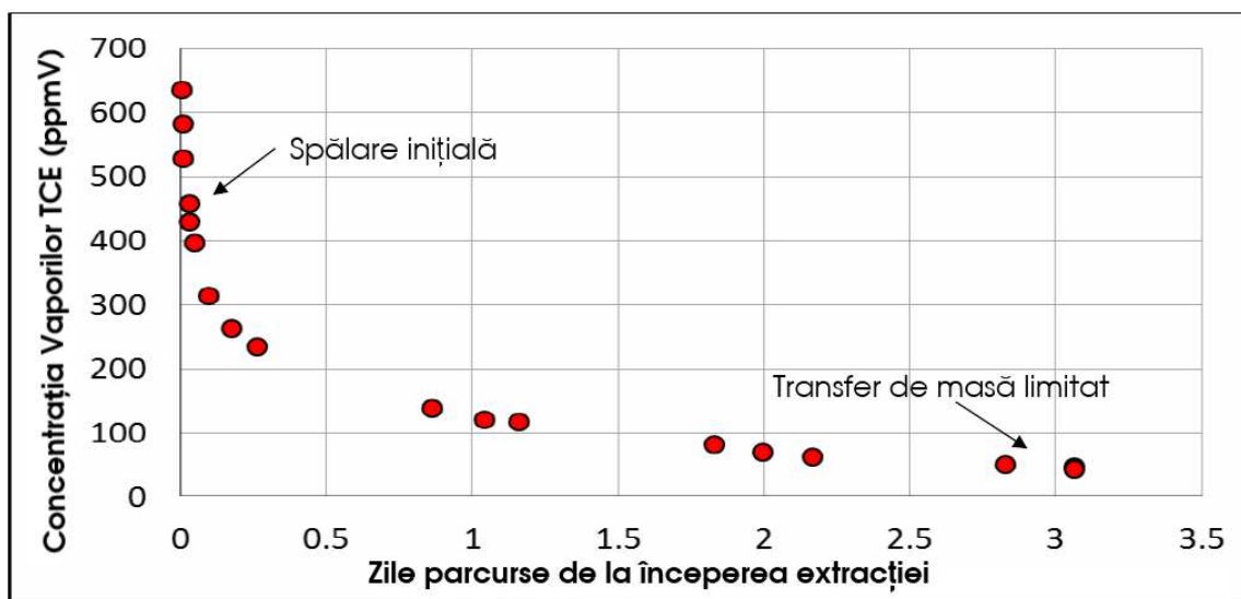
Figura 4.2- Exemplu de date privind concentrația de vapori de la un test pilot SVE
