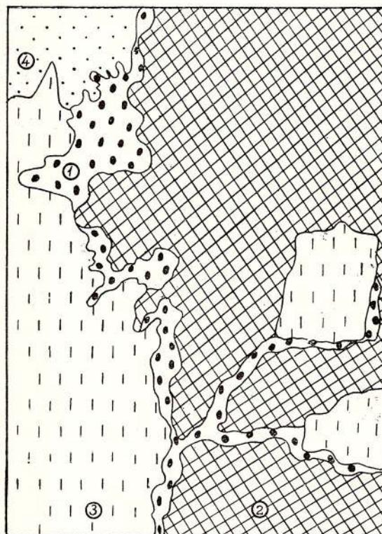
Fig. 39. — Tetraedritul (1) se insinuează pe contactul dintre cuarț II (2) și blendă I (3) ori cuarț și calcopirită (4).  $\times 34$ .
