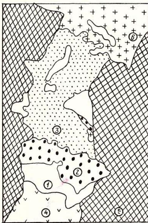
Fig. 48. — Bournonitul (1) apare asociat cu tetraedrit (2), calcopirită (3) și marcasită (4) în filonașe ce străbat cuarțul (5). Calcopirita corodează pirită (6) fiind corodată de tetraedrit și bournonit.  $\times 32$ .
