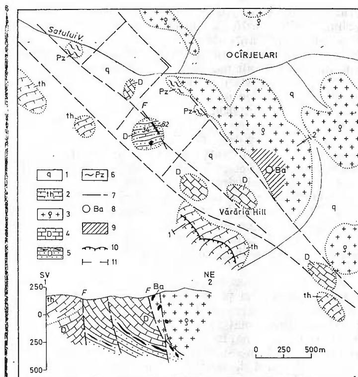
Fig. 1. Schiță geologică a zonci Cirjelari-Dealul Vărăria : 1, loess ; 2, calcare tithonice ; 3, riolite alcaline ; 4, calcare recristalizate devoniene ; 5, roci detritice devoniene ; 6, formațiuni paleozoice nediferențiate ; 7, fale ; 8, ivirea cu blocuri de baritină ; 9, silicifери ; 10, carieră ; 11, secțiune geologică.
