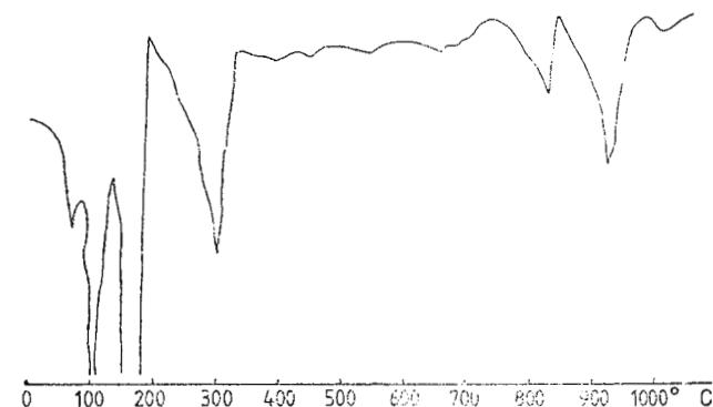
Fig. 5. Curbe termice diferențiale a asociației goslarit-hexahydrit de pe galeria direcțională a filonului 142, orizont superior.
