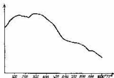
Fig. 1. — ATD pentru muscovitul de Cataracte — cu derivatograful de tip MOM-Budapesta.
