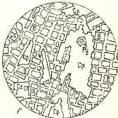
Agregat de sulfuri în gangă de cuarț Py-pirită; Cp-calcopirită; B-blendă; Cx-calcocină
