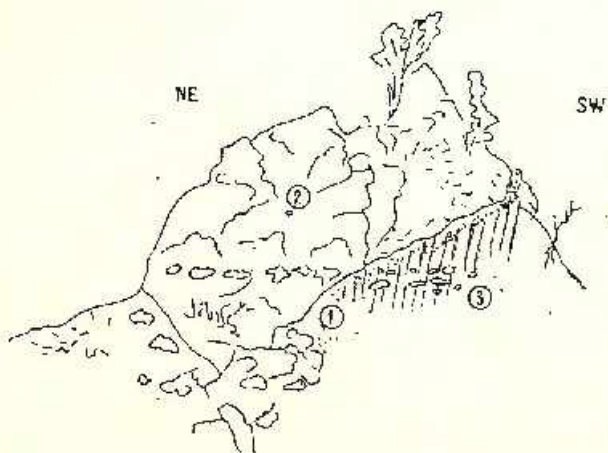
Fig. 13. — Aglomerate (3) și tufuri, argilizate (1) și silicificate (2) în partea de nord a dealului Coșu.
