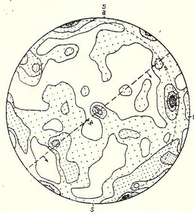
Fig. 9. — 200 axe optice de cuarț în filit sericitos (Isvorul-Rece).
