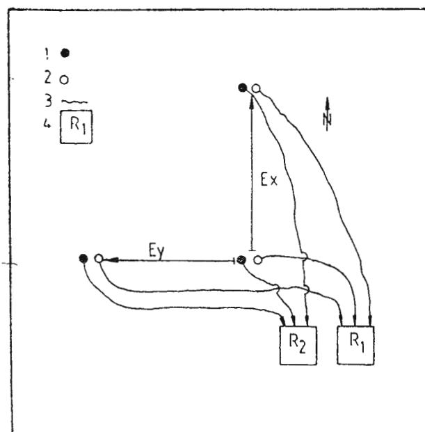
Fig. 5 – Amplasarea dispozitivelor de înregistrare în timpul experimentării tipurilor de electrozi. 1, electrod impolarizabil; 2, electrod polarizabil; 3, cabluri de conexiune; 4, echipamente pentru înregistrări telurice.
