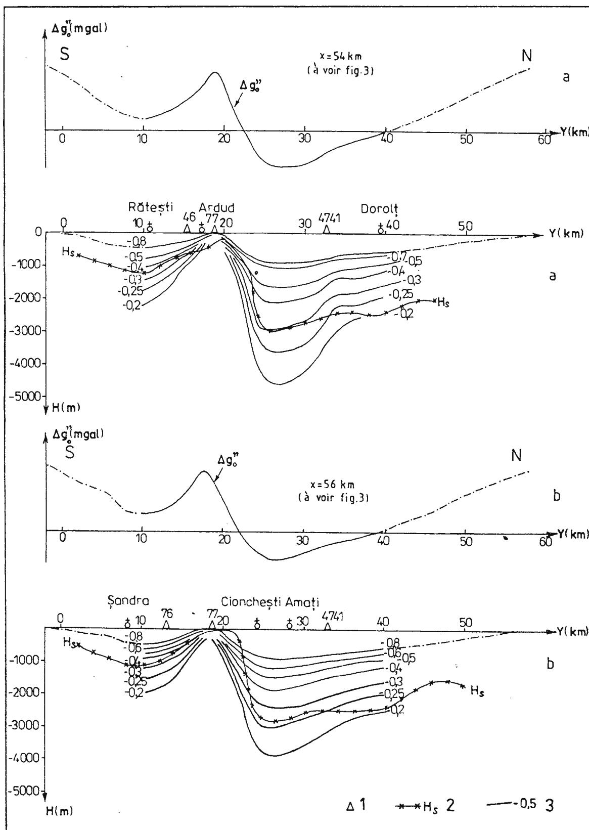
Fig. 5 Interprétation 2D des données gravimétriques sur les profils 54 (a) et 56 (b). 1, forages; 2, base du Néogène d'après les données sismiques et de forage; 3, base du Néogène résultant de l'interprétation des données gravimétriques, pour des contrastes de densité de 0.2 à 0.8 g/cm<sup>3</sup>.
