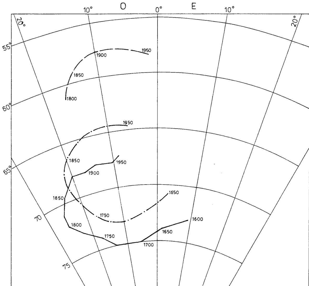
Fig. 1 – Variation de la direction du CMT tracée d'après des mesures directes: - à Londres jusqu'à 1600; - à Paris jusqu'à 1650; - à Rome jusqu'à 1800.
