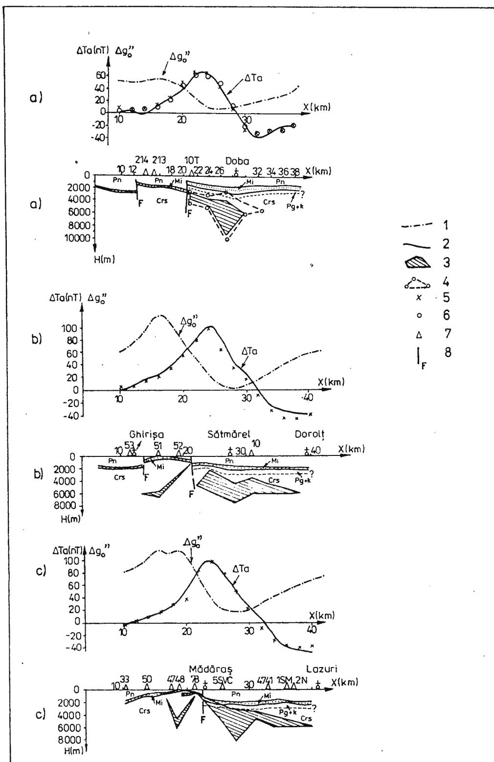
Fig. 6 – Résultats de l'interprétation 2D de l'anomalie aéromagnétométrique  $\Delta T_a$  sur les profils 42 (a), 48 (b) et 52 (c).
