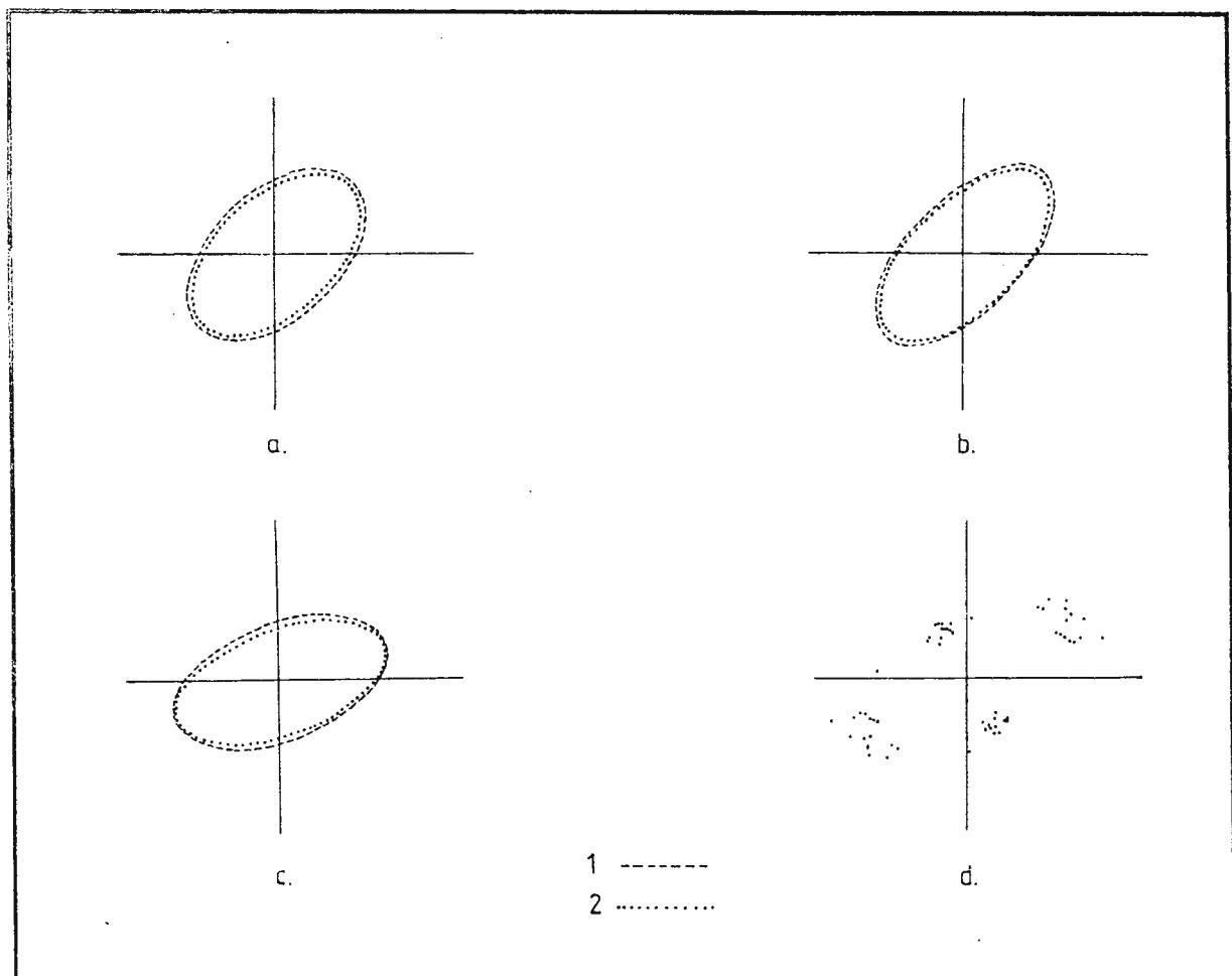
Fig. 6 – Elipse determinate pe baza potențialelor măsurate între electrozi impolarizabili ( $Pb-PbCl_2$ ). 1(a,b,c), elipse determinate cu echipamentul R1; 2(a,b,c), elipse determinate cu echipamentul R2; (d), nor de puncte corespunzător extremităților elipselor calculate pentru R1.
