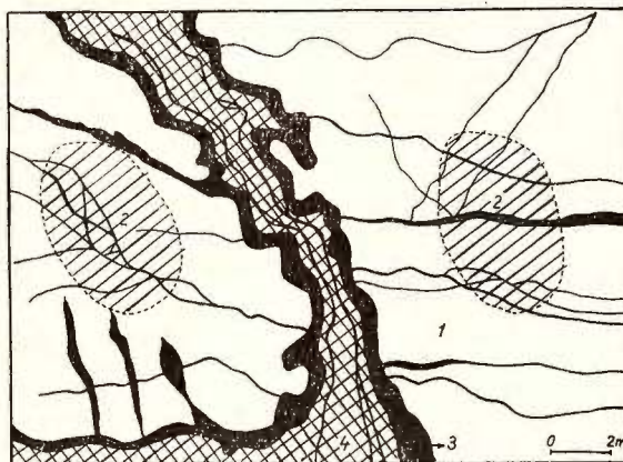
Fig. 2. — Andezit argilizat (1) cu blocuri relice de andezit adularizat (2) străbătut de diaclaze cu calcedonie (3) și cuarț (4).
