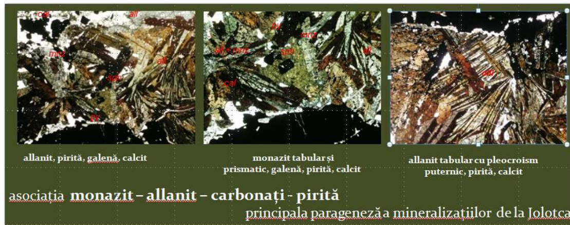
Fig. 6 Imagine microscopică: monazit tabular și prismatic, galenă, pirită, allanit – mineralizația filoniană Jolotca
