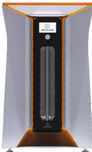
Fig. 2. Echipament pentru scanarea carotelor, cu suport cilindric de 1 m lungime pentru probe.
