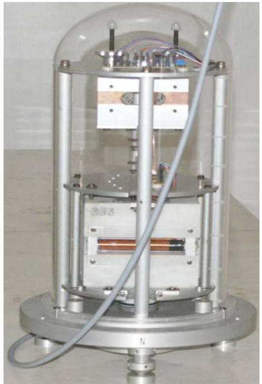
**Magnetometrul protonic Overhauser GSM90** este un magnetometru scalar proiectat pentru observatoare magnetice sau alte aplicatii (vulcanologie), unde stabilitatea si acuratetea sunt strict necesare. Cu o rezolutie de 0.01 nT, acuratetea absoluta de 0.2 nT si un drift de 0.05 nT/an poate fi folosit cu succes in calculul valorilor de baza pentru un observator magnetic.
